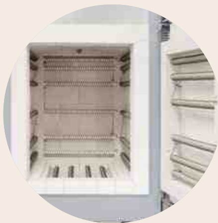
Verwarming van vijf zijden op draagbuizen en speciale indeling van de verwarmingselementen zorgen voor een optimale temperatuuruniformiteit
