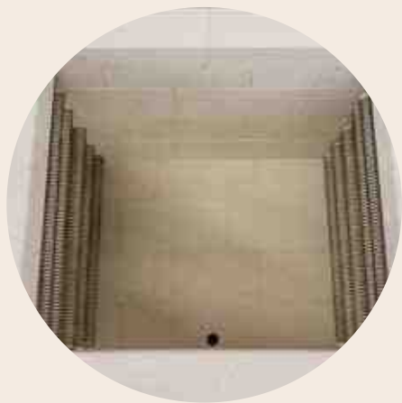
Verwarmingselementen op draagbuizen aan beide zijden zorgen voor ononderbroken warmtestraling
