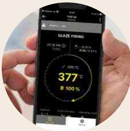
Pushberichten in geval van storingsmeldingen
