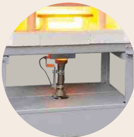
15 kW propaangasbrander gemonteerd onder de oven
