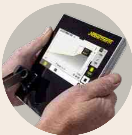
Vastleggen van gegevens over het stookproces van de aangesloten controller via USB-drive
